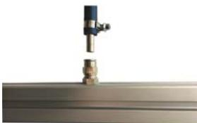
Соедините пневматическим шлангом муфту направляющей стрелы с муфтой каретки.
