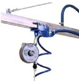
Введите в зацепление с карабином каретки подвес (балансир) для инструмента. Закрепите пневматический инструмент на подвесе. Подключите пневматический инструмент к витому шлангу консоли.
