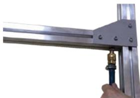
Подключите поворотную консоль к источнику сжатого воздуха через входной штуцер.
