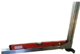
Закручивая или ослабляя талреп, установите направляющую стрелу горизонтально. Контролируйте установку направляющей стрелы по уровню
